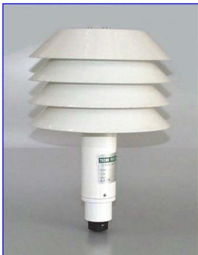
Il sensore di temperatura dell'aria (TP-TAR) è uno strumento realizzato secondo le indicazioni del WMO. L'elemento sensibile (termoresistenza al platino) viene protetta dalla pioggia e dalla radiazione solare incidente per mezzo di quattro schermi circolari sovrapposti che permettono comunque la circolazione dell'aria attorno ad esso. Il condizionatore di segnale è contenuto in una custodia posta sotto gli schermi.
